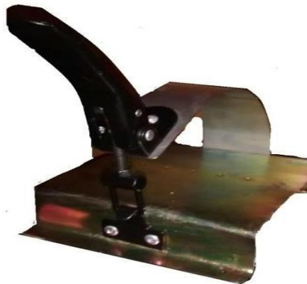
Abrazadera de extracción rápida: No se pueden precintar ni pegar con cinta adhesiva.
